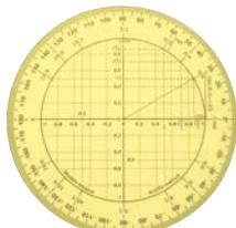
Le rapporteur trigonométrie permet la lecture directe de la mesure des angles en degrés et en radians, ainsi que des valeurs des cosinus et des sinus à 0,05 près - The trigonometric protractor allows direct reading of angle measurements in degrees and radians, as well as cosine and sine values to within 0.05. Il permet d'estimer la valeur approchée du cosinus et du sinus d'un angle - It allows to estimate the approximate value of the cosine and sine of an angle.
